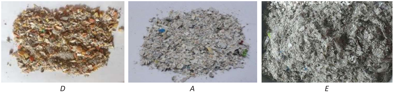
Hình 1. Mẫu vụn nhựa thải được sử dụng trong nghiên cứu này (D: Nhựa màu HDPE; A: Thùng sơn nhựa HPDE; E: Chai nhựa PET)
